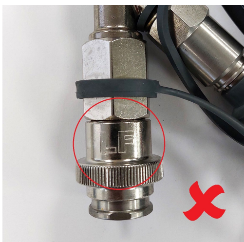
Fig 3. Mauvais connecteur de sortie à faible force (LF)
