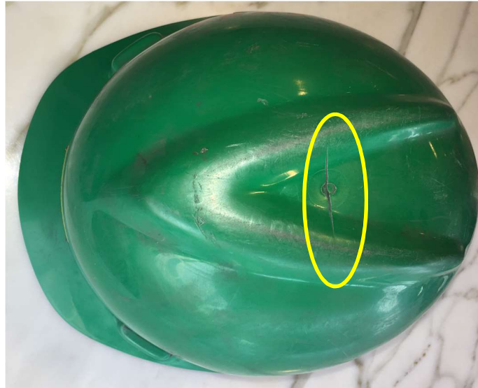
Figure 1 - Fissuration dans un casque de protection MSA V-Gard de couleur verte
